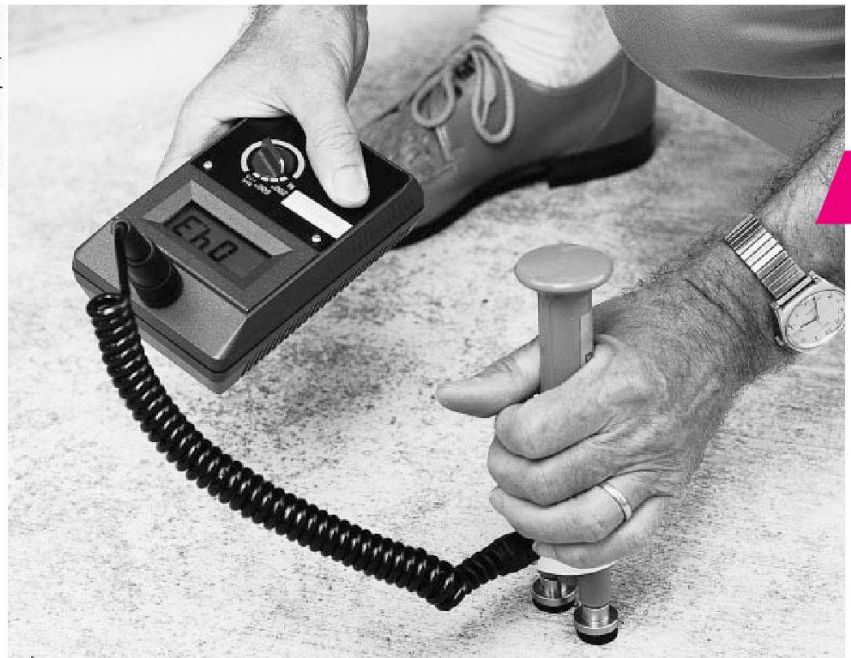
Die Messung des elektrischen Widerstands ist ein schnelles, aber nicht sehr genaues Verfahren zur Bestimmung der Betonfeuchte.
