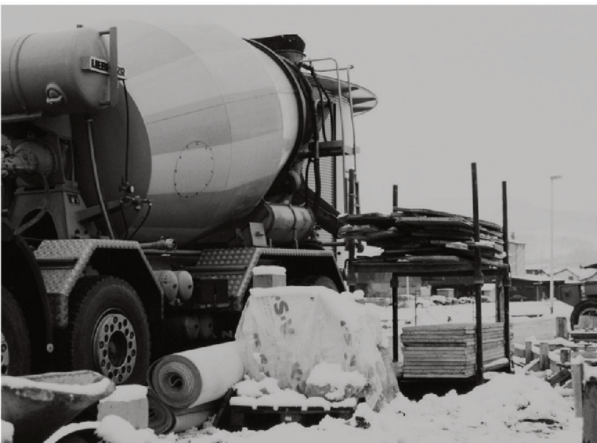
Transportbeton ist zu jeder Jahreszeit einsetzbar – auch im Winter, wenn die notwendigen Vorkehrungen getroffen werden [18].
