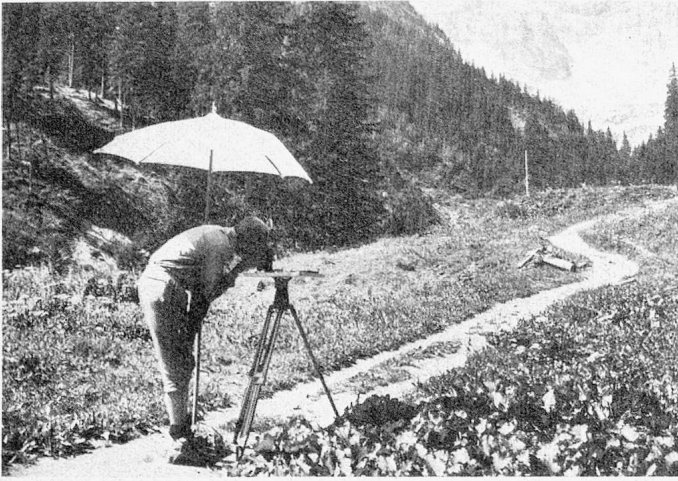
Levé des détails topographiques exécuté à l'aide de la planchette
