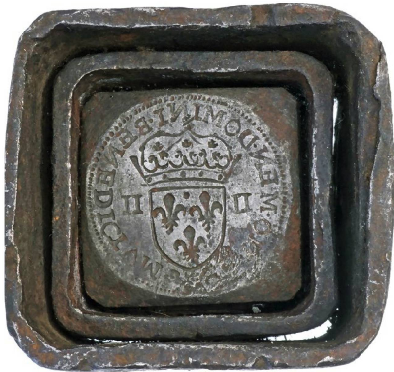
Un coin de fer mobile pour la frappe au mouton ou au balancier du 1/4 d'écu. Royaume de France, Henri IV (1589-1610), atelier indéterminé.
