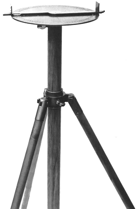
F: Nach dem Entfernen der Bussole ist die horizontierte und orientierte Mess-Schyben mit aufgesetzter Alhidade für Vermessungsarbeiten einsatzbereit.
