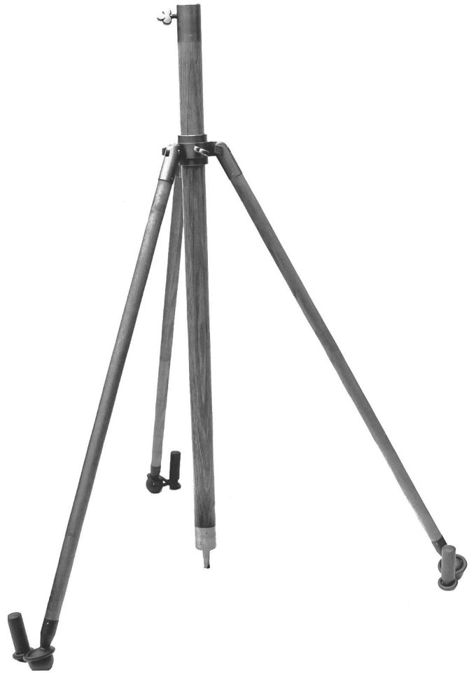
B: Das Stativ mit der zentralen, senkrechten Säule und den drei Streben, welche die Säule in ihrer Stellung fixieren.
