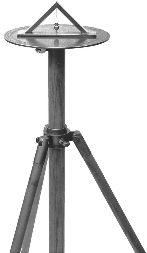
C: Das Horizontieren der Mess-Schyben mittels der Blywag (Bleiwaage, auch Setzwaage genannt).
