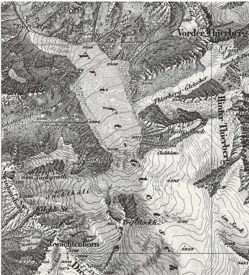
Abb.9: Ausschnitt «Trift-Gletscher» (siehe Abb. 8) im Originalmassstab 1:50 000. Schattenschraffen und Relief-ton in Südwest-Beleuchtung, Firn und Gletscherdarstellung mit Horizontalkurven. Der Triftgletscher reicht noch bis zur Trift-Alp hinunter, und die bereits existierende Clubhütte des SAC kann mühelos über den Gletscher erreicht werden.
