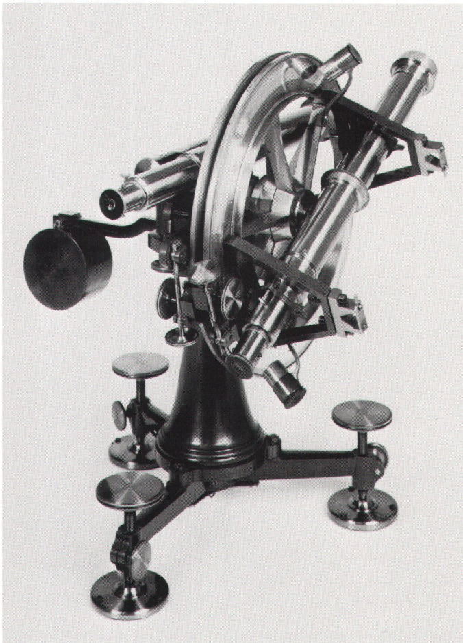
Abb. 7. Achtzölliger Multiplikations-Theodolit von Reichenbach-Utzschneider, München (1819). Links für Vertikalwinkel, rechts für Horizontalwinkel eingerichtet. (Bundesamt für Landestopographie, Wabern).
