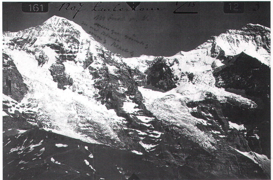
Abb. 8: Eine der Grundlagen für Abb. 9: Terrestrische Aufnahme von 1926 ab der Station Lauberhorn mit der Bemerkung Mönch v. N., weniger günstig, zu viel Schnee, wenig Plastik , welche die Schwierigkeiten des Photogrameters deutlich vor Augen führt (Photothek L+T).
