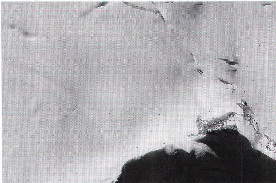
Abb. 10: Ein Gletscher mit «Laubflecken»: Damit der Aletschgletscher überhaupt photogrammetrisch ausgewertet werden konnte, musste er zuerst künstlich mit über 10 000 Punkten aus Sägemehl und Russ versehen werden. Ausschnitt einer Partie auf dem oberen Jungfraufirn südlich der Sphinx (Photothek L+T, Aufnahme 4077 aus der Fluglinie 3a / ALETSCHE vom 20. 8. 1957). Der Mönch selbst wies genügend Kontrast auf und musste nicht zusätzlich «getupft» werden.
