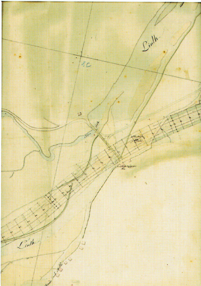
Abb. 5: Ausschnitt Mollis/Näfels aus dem Plan des projektierten Kanals von Näfels bis ins Gäsli. Von Hans Jakob Frey aus dem Jahr 1807. Massstab 1:2000, 240 x 85 cm (LIAR F 2.2.1).
