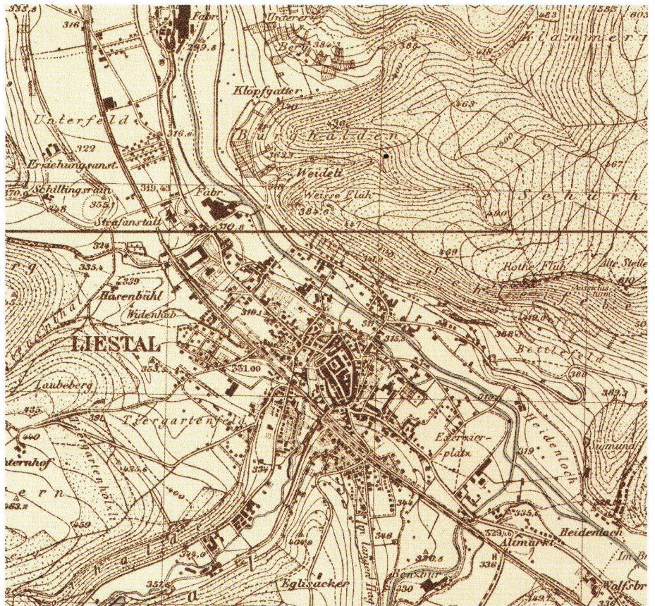
Abb. 4: Ausschnitt aus dem Blatt 20 Liestal der Sonderausgabe Schweiz 1:25 000. Als Grundlage diente die dreifarbig «Siegfriedkarte», die vom deutschen Kriegskarten- und Vermessungswesen in eine zweifarbig Karte umgearbeitet wurde. Ausserdem wurde das schweizerische Koordinatennetz durch das deutsche Gauss-Krüger-Gitter ersetzt. Dieses Blatt erschien im Oktober 1940. (Wabern, Bundesamt für Landestopographie, Kartensammlung, K81 S25:20, 1940).
