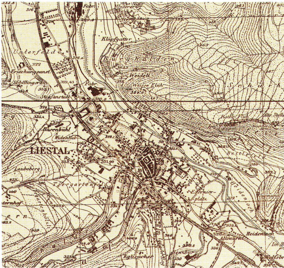
Abb. 6: Ausschnitt aus dem Blatt 20 Liestal der Deutschen Heereskarte Schweiz 1:25 000. Gegenüber der Sonderausgabe wurde der topographische Inhalt auf Grund von Luftbildern des Sommers 1943 nachgeführt und das Gauss-Krüger-Gitter durch das Deutsche Heeresgitter ersetzt. Der Druck dieses Blattes erfolgte im Dezember 1944 in einer Druckerei mit der Tarnbezeichnung D47. (Wabern, Bundesamt für Landestopographie, Kartensammlung, K80 S25: 20, 1944).
