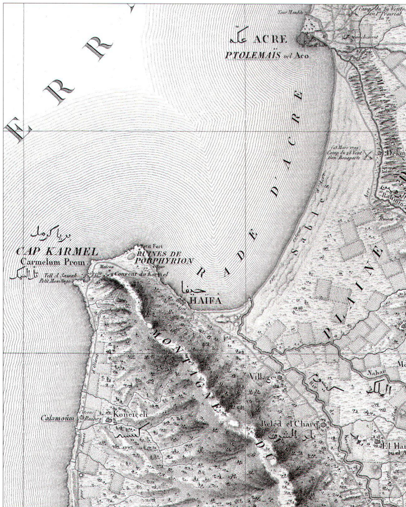
Abb. 11: Während der erfolglosen Belagerung von Akko vermass Pierre Jacotin eine Basis und nahm das Gelände mit Messtisch und Theodolit auf. Carte topographique de l'Égypte . Blatt 46, Ausschnitt auf 60% verkleinert.
