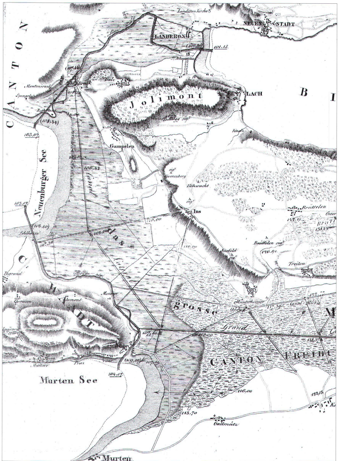
Abb. 8: Plan Général du projet concernant le désèchement du Marais de Seeland y comprise la correction de l'Aar, 1834. 1:50 000. Sehr genaue Kopie der General Chartre von 1816/17 (siehe Heftumschlag), ergänzt mit Höhenkoten (identisch mit Plan, Abb. 12–15) und den Projekten von Tulla und Lelewel. Einfarbige Lithographie, Kartenausschnitt auf 70% verkleinert. Gut erkennbar sind die neuen Landflächen, die durch die Senkung der Seespiegel gewonnen wurden (Staatsarchiv Bern, AA V 404).
