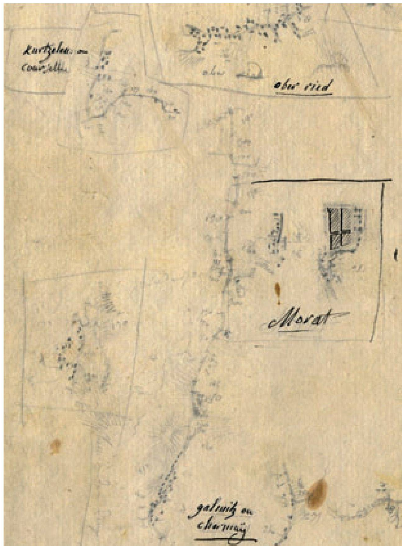
Abb. 10: Vereinfachte Aufnahmeverfahren bei Siedlungen in der Gegend von Murten und Galmiz. Die in Bleistift entworfenen Grundrisse mit eingetragenen Distanzen im Schrittmass unterstreichen den behelfsmässigen Charakter dieser Aufnahme. (IGN St-Mandé, SGN, caisse 48, paquet 1).
