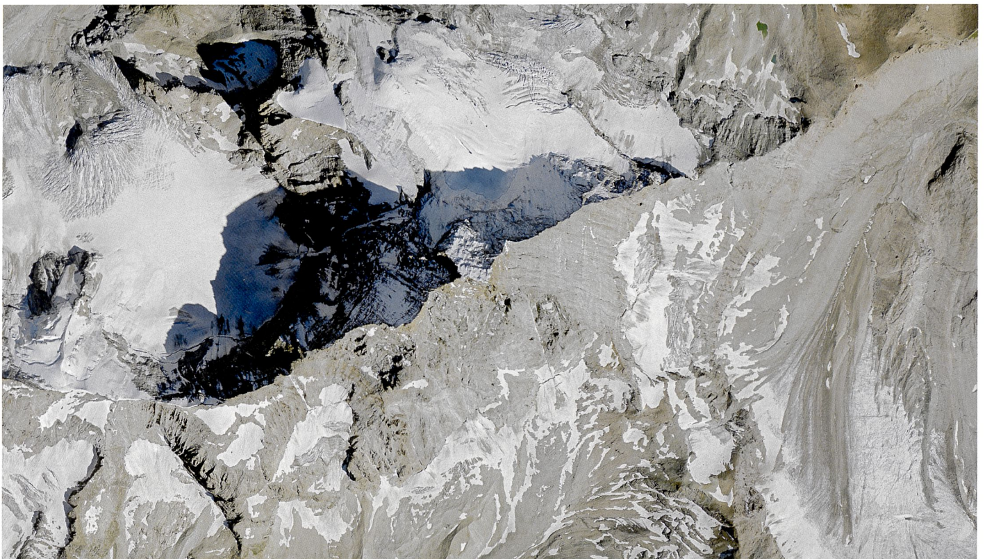
Abb. 51: Ausschnitt aus LK 1:25 000, Blatt 1347 Matterhorn , Ausgabe 2012. Schichtgravur auf Glasplatten (Erstausgabe 1969), Offsetdruck 8-farbig. Felsgravur von Roger Briner (1926–2003), Reliefdarstellung von Eduard Geissbühler (1922–2011) (swisstopo BA15049).
