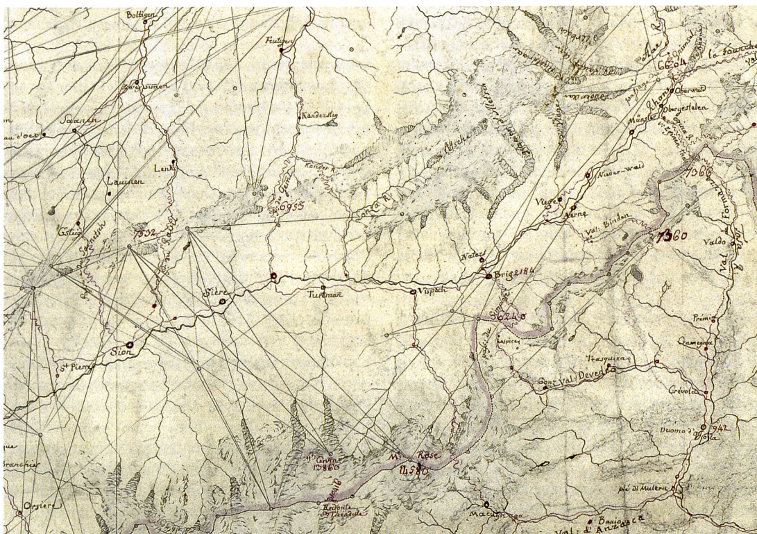
Abb. 59: Ausschnitt aus dem Manuskript der Carte de la Suisse avec canevas trigonometrique (ca. 1:435 000) mit Triangulationsnetz. Vom Oldhorn, vom Wildhorn, aus der Gegend des Rohrbachsteins und vom Sidelhorn aus sind graphische Richtungsmessungen auf den «Mt. Cervin 13860» eingezeichnet. Diese von de Saussure ermittelte Höhenangabe in französischen Fuss entsprechen 4502 m (SHD-DAT, 6M, N 14.3.A.22).
