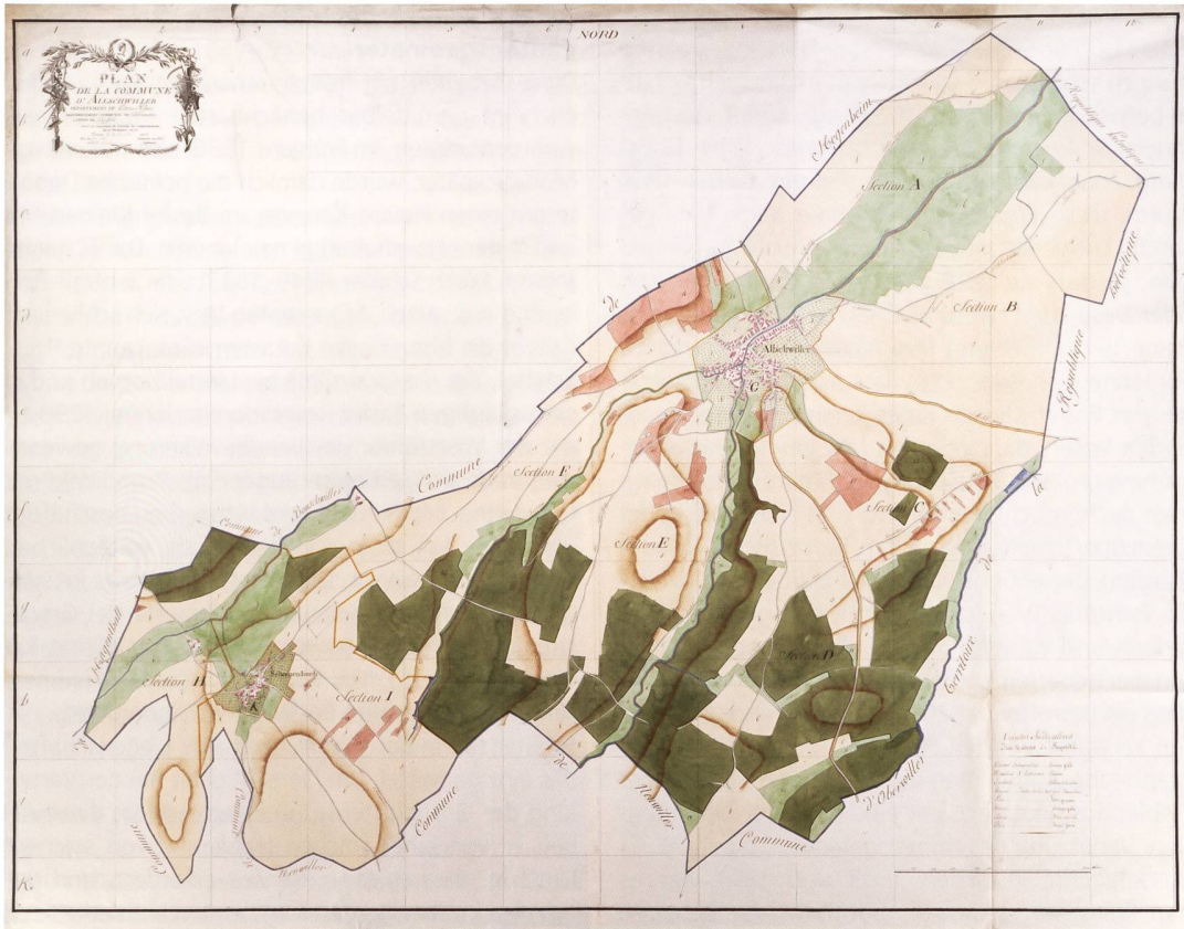
Abb. 28: Plan de la commune d'Allschwiller, Département du Haut Rhin, Arrondissement communal de Délemont, Canton de Lauffon. Dieser französische Übersichtsplan im Masstab 1:5000 mit farbiger Unterscheidung der verschiedenen Nutzungsarten wurde am 15. September 1803, nur zehn Monate nach Erlass des ihm zugrunde liegenden Gesetzes fertiggestellt. 118x90 cm (SHD-DAT, L II.951 fol. 1 Allschwiller).
