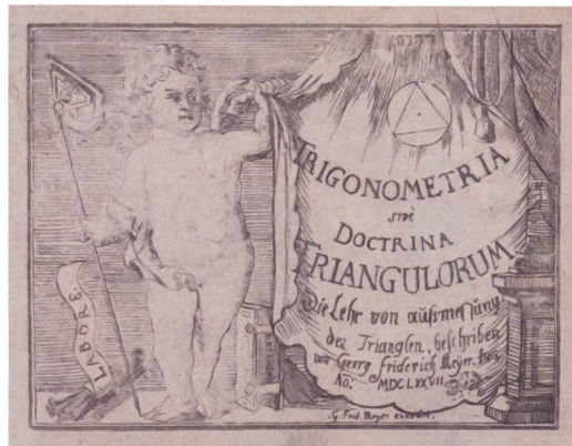
Abb. 6: Das Titelbild von Georg Friedrich Meyers Lehrbüchlein Trigonometria sive Doctrina Triangulorum – Die Lehr von ausmessung der Triangeln , beschrieben von Georg Frierich Meyjer Ing. A[nn]o MDCLXXVII. zeigt im linken Teil das Halbkreisinstrument auf einem Stockstativ zur Messung der Brechungswinkel in den Polygonzügen und darunter am Boden eine Messkette zur Messung der Distanzen (ETHBIB, Rar 4495. Online http://dx.doi.org/10.3931/e-rara-2947 ).
