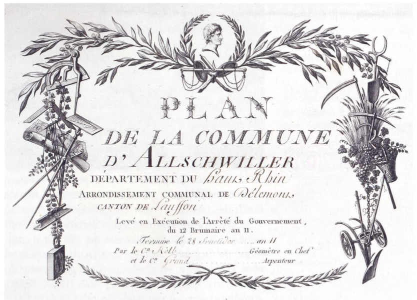
Abb. 28a: Titeltartusche des Plan de la commune d'Allschwiller . Ausschnitt aus Abb. 28. Direkt unter dem Kopfprofil Napoleons verkörpert eine Waagschale das mit der Vermessung angestrebte Ziel der Schaffung von Gerechtigkeit. Am linken Rand sind Vermessungsinstrumente abgebildet, am rechten Rand landwirtschaftliche Geräte und Erzeugnisse.
