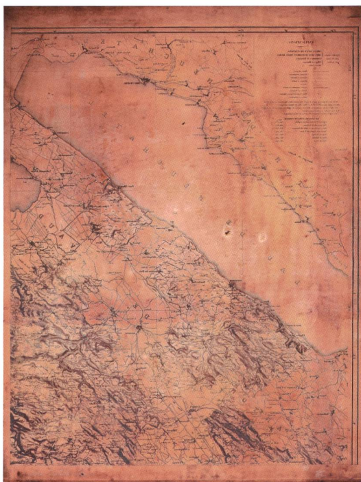
Abb. 54: Kupferplatte für Blatt I der Kantonskarte 1:50 000, Format: 59 x 75 cm, Dicke ca. 2,5 mm. Bildformat: 51 x 67 cm (MKGf 3855a).
