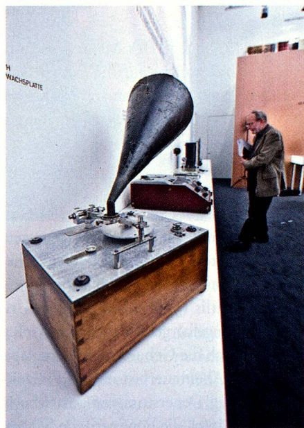
Mit dem «Wiener Phonograph» von 1909 wurden Tonaufnahmen auf Wachsplatten gespeichert
