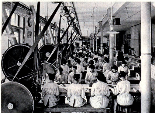
Kempthal 1896: Trabajo en cadena en la fábrica de Maggi. Antes de su electrificación, la cadena de montaje para el envase era accionada por equipos de transmisión mecánica.
