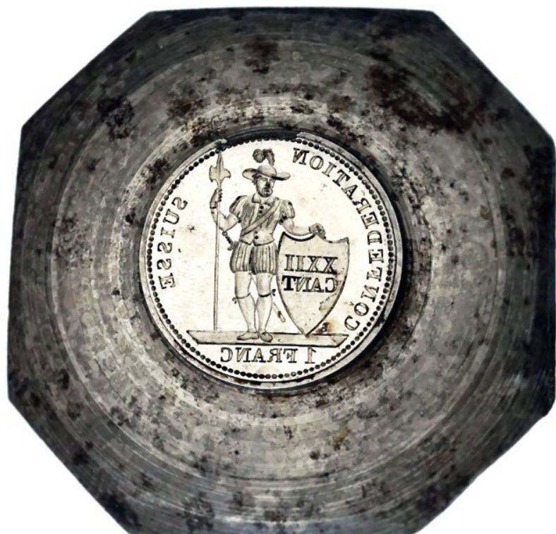
Troquel para la acuñación a molino de 1 franco con escudo. Cantón de Vaud, Lausana, 1846.
