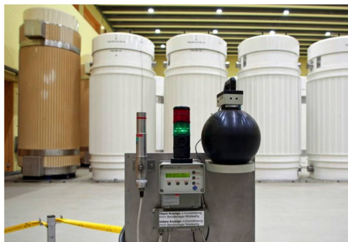
Contenedores para residuos altamente radiactivos, en el centro de almacenamiento provisional de Würenlingen, con medidores de control en primer plano. Foto Keystone
