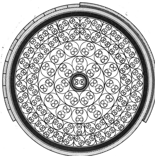
Fig. 28. Querschnitt des Kabels mit 81 Vierern.
