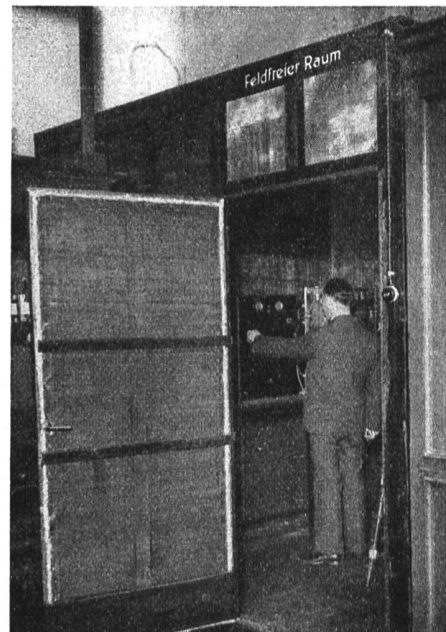
Abb. 2. „Feldfreier“ Raum zur Empfängerprüfung.
