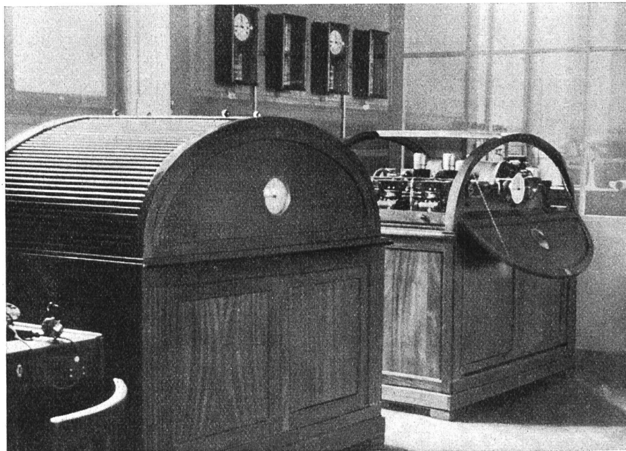
Fig. 1. Gesamtansicht der sprechenden Uhr „Brillie“ und der Reservegruppe. Vue d'ensemble de l'horloge parlante „Brillie“ et de l'horloge de secours.
