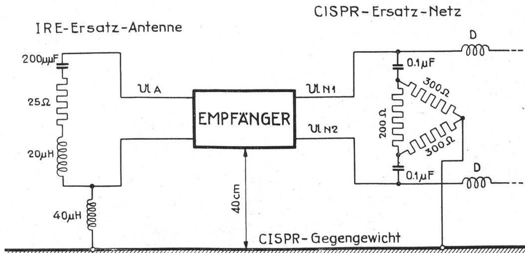
Abb. 1. Beschaltung des Empfängers zur Messung der störenden H.-F.-Spannungen.
