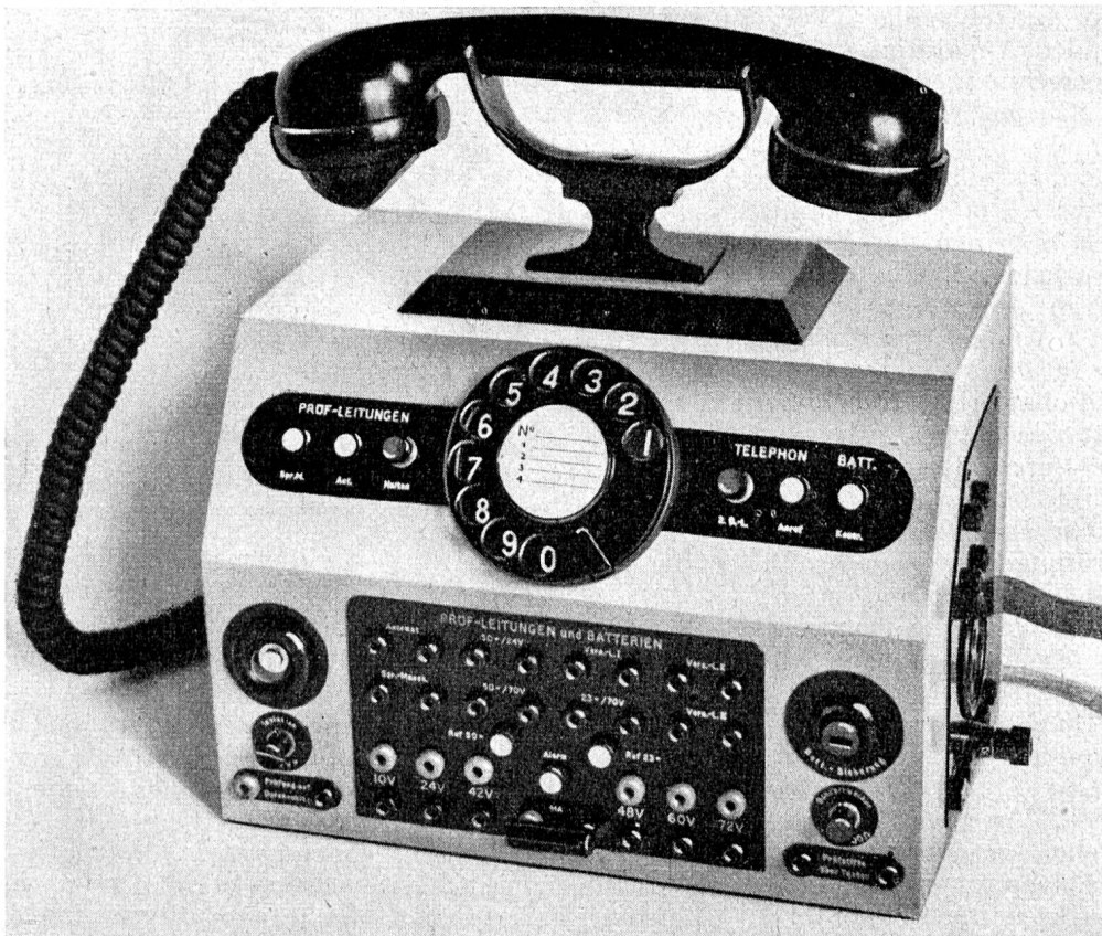
Fig. 1. Prüfkasten für Telephonmaterial. — Boîte d'essais pour le matériel téléphonique.
