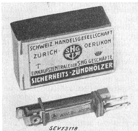
Fig. 5. Miniaturrelais des Impulswiederholers (Grössenvergleich mit einer Streichholzschachtel) Relais miniature du répéteur d'impulsions (grandeur comparée à celle d'une boîte d'allumettes)
