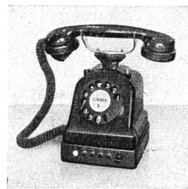
Fig. 4. Station mit Signal-Untersatzsockel für Hauptstelle
