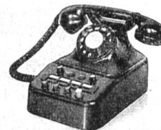
Fig. 12. Kontrollstation zum Mithören von Amtsgesprächen
