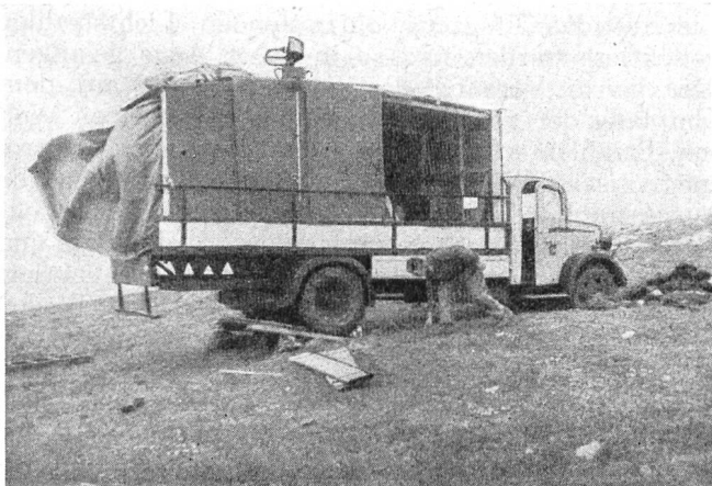
Fig. 2. RADAR-Station auf einem Lastwagen montiert
