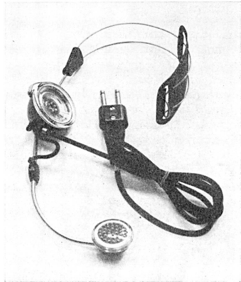
Fig. 9. Poste combiné micro-téléphone type 52A pour les opératrices du service téléphonique interurbain
