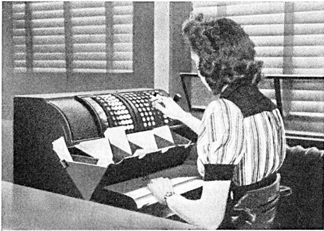
Fig. 55. Machine imprimeuse-totalisatrice pour l'établissement des factures destinées aux abonnés
