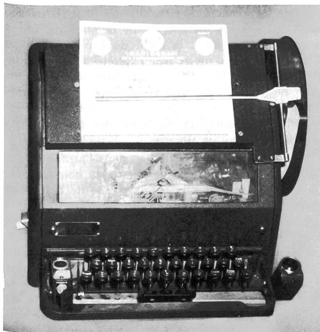
Fig. 1. Fernschreibe-Apparat, ein sogenannter Typing-Reperforator, auf dem die Lochstreifen gestanzt werden
