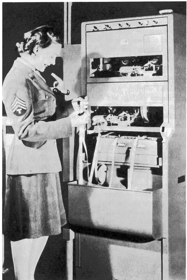
Fig. 3. Kombinierte Sende- und Empfangsapparatur, wie sie vom U. S. Army Signal Corps entwickelt wurde
