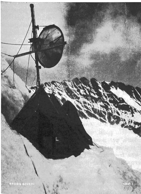
Fig. 1. Installation d'essais de transmission par ondes dirigées de 15 cm à la Pointe Mathilde (massif de la Jungfrau), à 3560 m d'altitude. Le réflecteur parabolique est orienté dans la direction du Monte Generoso. Les instruments de mesure et l'appareillage auxiliaire sont installés dans deux tentes. Au fond, le Trugberg.
