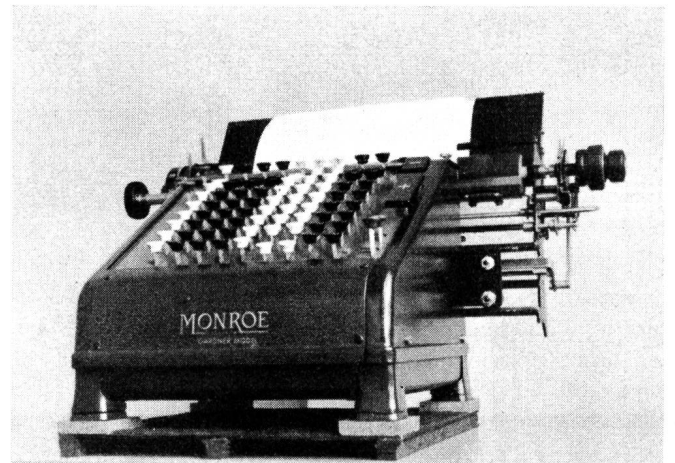
Fig. 7. Rechenmaschine mit geräuscharmer Aufstellung Machine à calculer avec dispositif anti-bruit
