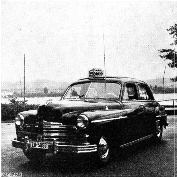
Fig. 3. Zürcher Auto-Taxi, eingerichtet für den Telephonverkehr. Auf dem linken Kotflügel die gleichzeitig für Senden und Empfang benützte, ausziehbare Antenne
