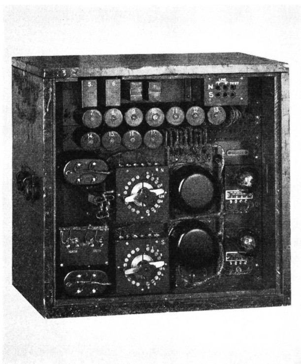
Fig. 6a. Répéteur à 2 fils «Western», vue avant
