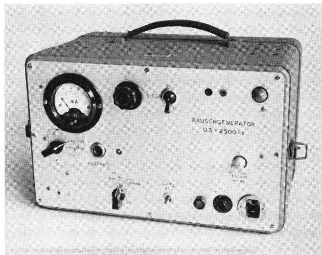
Fig. 6. Zur Eichung verwendeter Rauschgenerator
