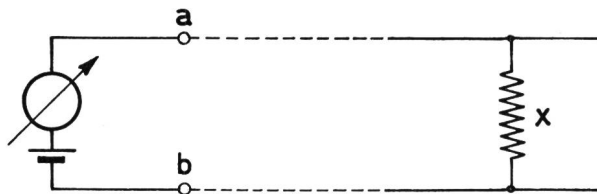
Fig. 1. Messung einer offenen Einzelleitung mit dem Isolationswiderstand x
