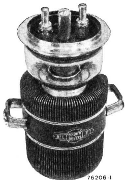
Fig. 2. Kurzwellensendetriode mit thoriierter Kathode für eine Verlustleistung von 6 kW
