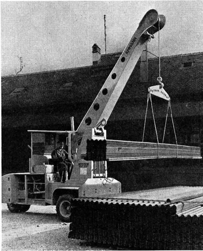
Fig. 12. Hyster-Kran für den Umlad von Schwermaterial Grue Hyster pour le chargement et le déchargement de matériel lourd
