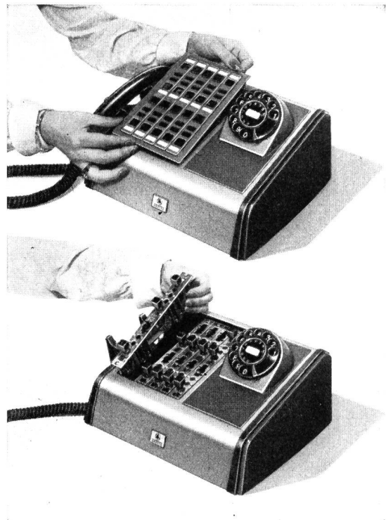
Fig. 2. Die leichte Zugänglichkeit zu allen Teilen der Albis-Telephonstation
