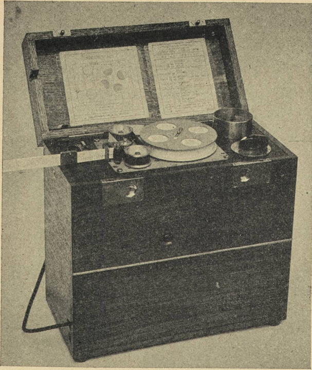
Apparat zur Kontrolle der Gesprächstaxierung
