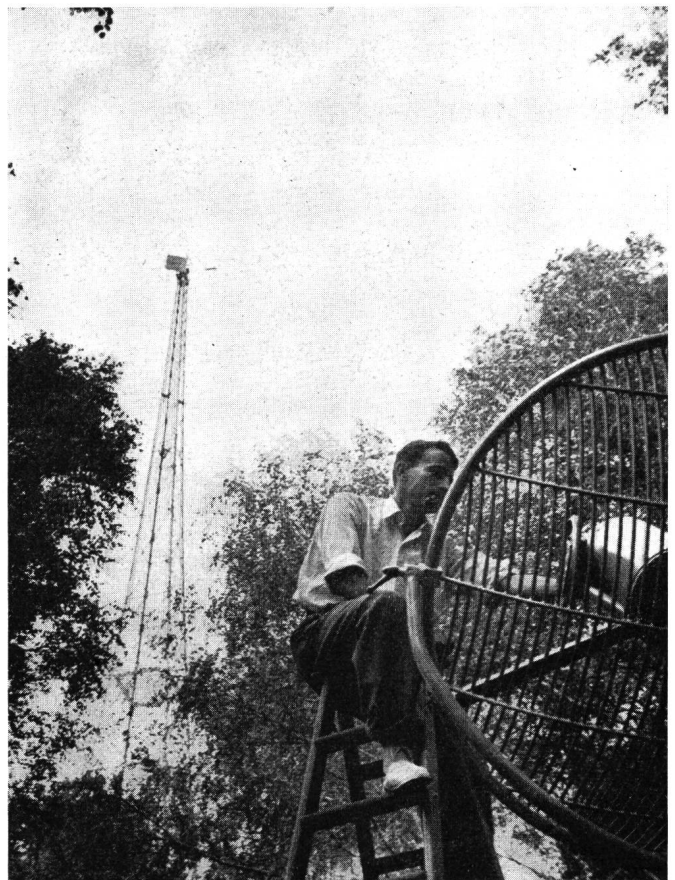
Fig. 7. Le relais passif monté sur le pylône du Monte Ceneri. Au premier plan, le récepteur de la liaison, en cours de réglage. \lambda = 6,5 cm Il ripetitore passivo installato sulla torre del Monte Ceneri. In primo piano la messa a punto del ricevitore del collegamento
