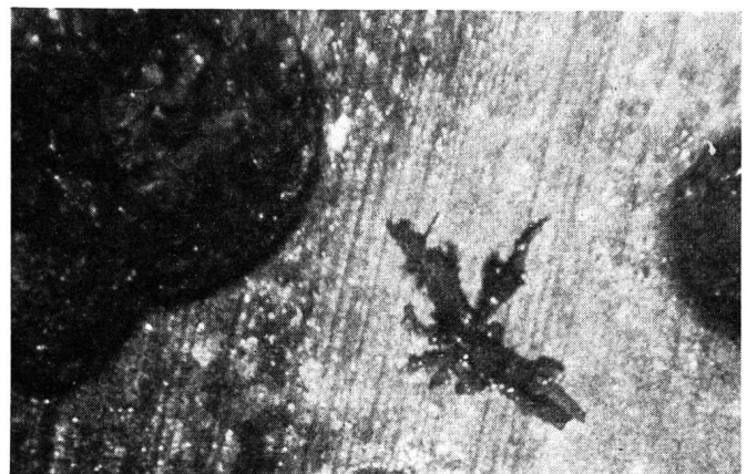
Fig. 6. Zwischen den runden Kratern, die durch die elektrolytische Bleiauflösung entstanden sind, wurde metallisches Blei in Form von Dendriten abgeschieden (gleiches Kabel wie bei Fig. 5). Vergr. 30 ×
