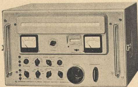
Kurzwellenempfänger Typ EK 07 0,5-30,1 MHz
