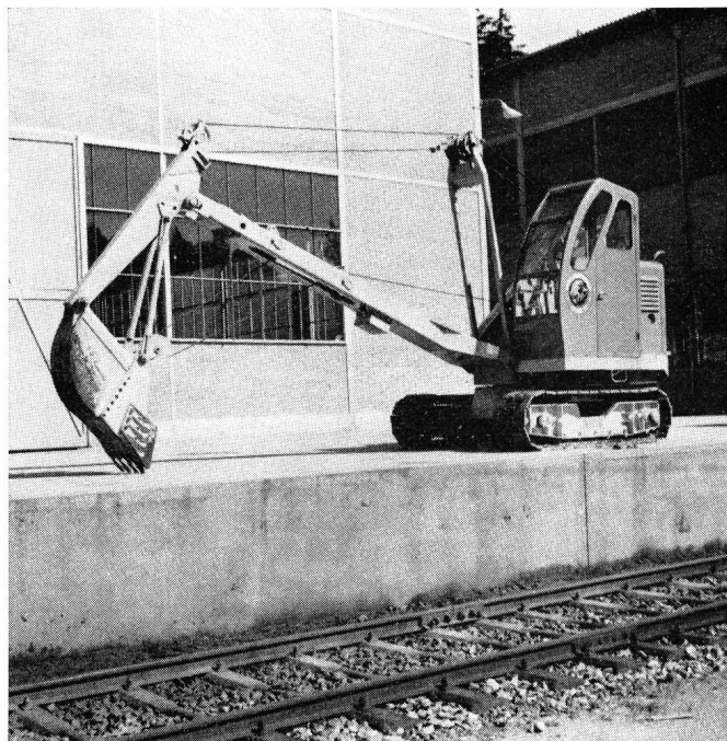
Fig. 2. Normaler Tieflöffelbagger Pelle mécanique équipée en rétro normale
