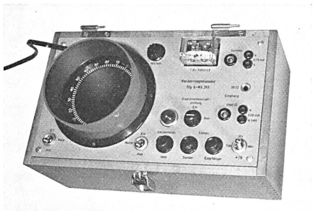
Fig. 1. Verzerrungsmesser Tfg 5-85.317. (Aussenmasse 280 × 170 × 165 mm)
