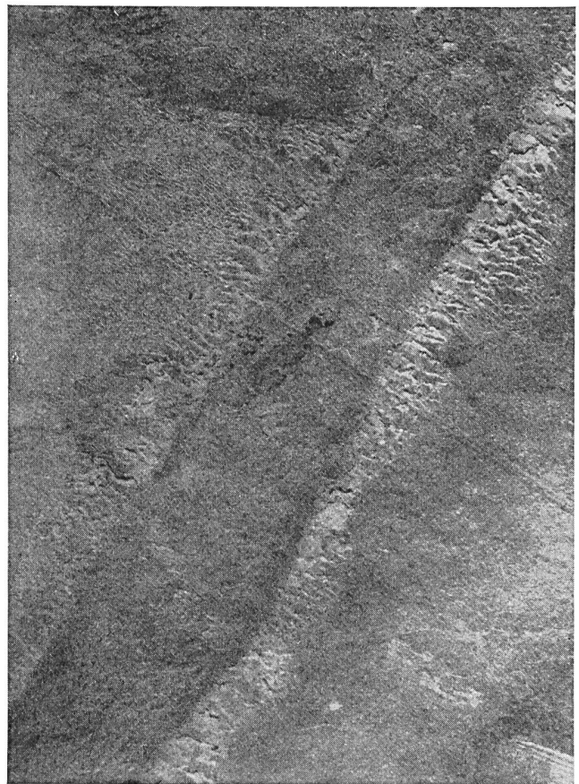
Fig. 35. Bei denselben Versuchsbedingungen, welche unter den Rohjuteschnüren eine kräftige Korrosion ergaben, korrodierte eine Bleiprobe, die mit geteerten Juteschnüren umwickelt war, praktisch nicht. Die in der Mitte der abgebildeten Spur sichtbaren Korrosionen sind nur ganz oberflächlich, so dass sie im Querschnitt nicht mehr erkannt werden können. Vergrößerung: 12×
