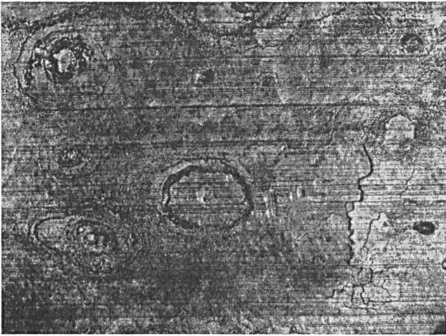
Fig. 5. Detail aus der Oberfläche der geteerten Bleiprobe der Figuren 1...4. Neben eingetätzten Furchen und Grübchen sind auch vereinzelte interkristalline Spalten aufgetreten. Vergrößerung: 4× Détails de la surface de l'échantillon de plomb enduit de goudron des figures 1...4. Outre des sillons et des petits cratères de corrosion, des fissures intercrystallines se sont également produites par places. Agrandissement: 4 fois
