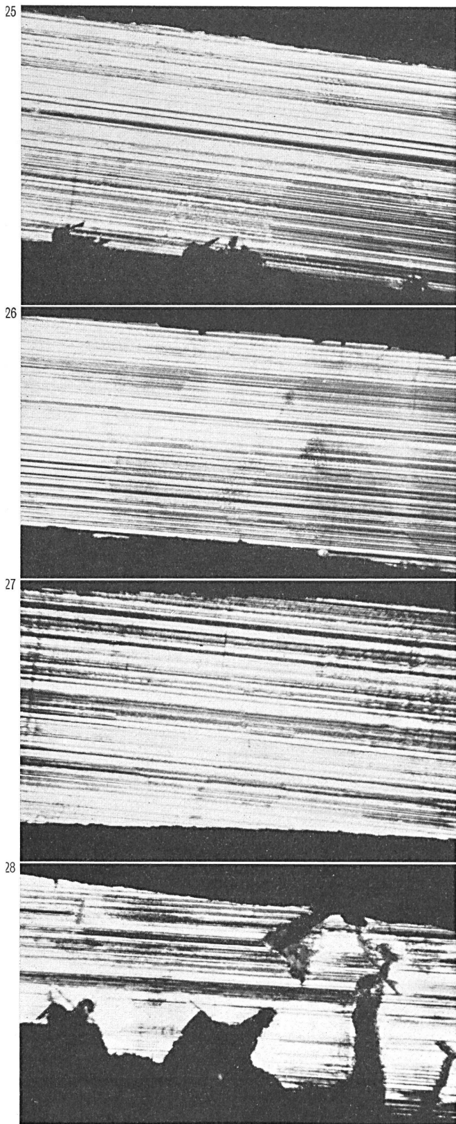
Fig. 25...28. Querschnitt durch Bleiprobe, die 5 Monate in 100 cm 3 Hellerscher Lösung lagen, die mit 1 g Substanz einer hochsiedenden Teerfraktion mit den Siedegrenzen 360...420° C (Fig. 25) oder 1 g Neutralkörper (Fig. 26) oder 1 g basischer Körper (Fig. 27) oder schliesslich 1 g saurer Körper (Fig. 28) der gleichen Fraktion versetzt war. Die unterschiedliche Schutzwirkung der verschiedenen Stoffgruppen ist augenfällig. Vergrösserung: 23 ×
