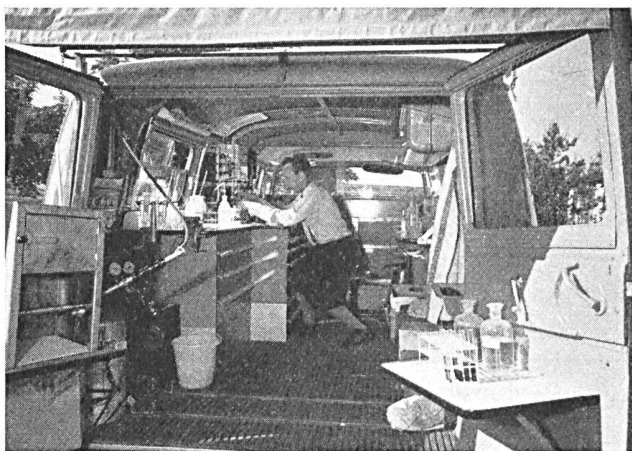
Fig. 6. Inneres des Korrosionslaborwagens
