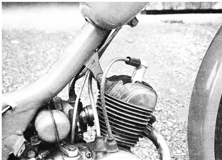
Fig. 7 Entstörung eines Motorfahrrades (Moped) Es wurde einzig ein abgeschirmter Entstörstecker auf die Zündkerze aufgesteckt Déparasitage d'un cycle à moteur (Moped) Il se réduit à un supprimeur blindé placé sur la bougie
